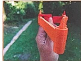
5: Fermer l'oeil droit : Avec l'oeil gauche on observe que le guidon orange est aligné avec le guidon rouge.
